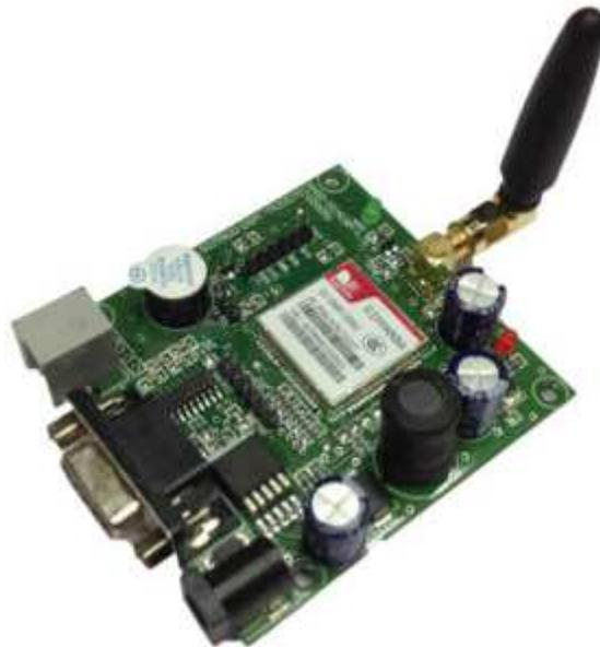
**Fig. 4.4 GSM Module SIM800**
